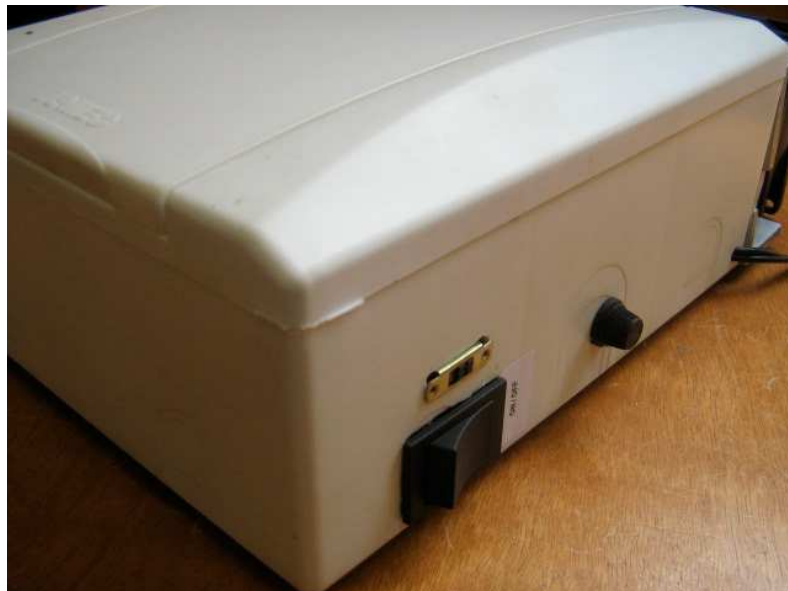
Figura 13: Botão liga/desliga e chave seletora 127V/220V
