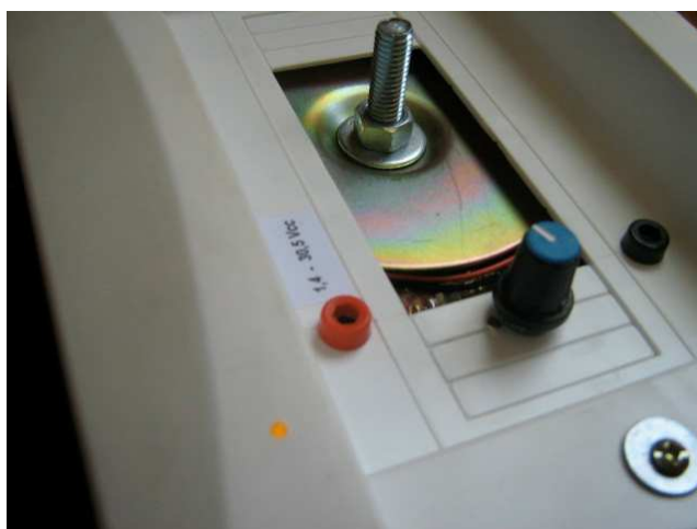
Figura 10: Potenciômetro e conectores da saída ajustável
