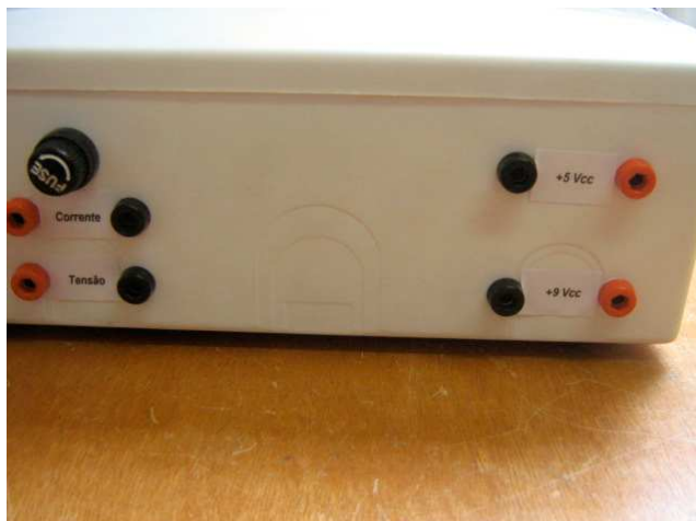
Figura 9: Conectores para os multímetros e das saídas 5V e 9V
